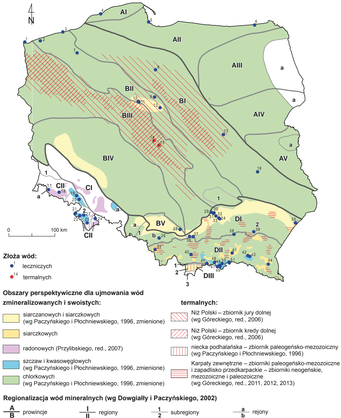
Fig. 5.1. Lokalizacja źródeł wód leczniczych i termalnych wykorzystywanych w balneoterapii na tle prowincji hydrogeologicznych oraz rozmieszczenia poszczególnych typów wód podziemnych
