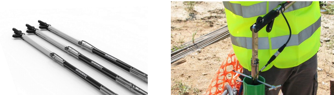
Rysunek 27 Przykład systemu IPI i jego wykorzystania do pomiarów w otworach pionowych (b) (fot, Sisgeo.com)
