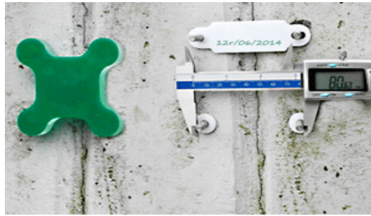
B wskaźniki do pomiaru rys, szczelin(fot. SHM System)
