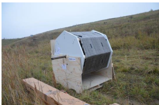
Rysunek 28 Sonda pomiarowych SAA firmy Measurand (fot. Budokop Sp Z o.o.)
