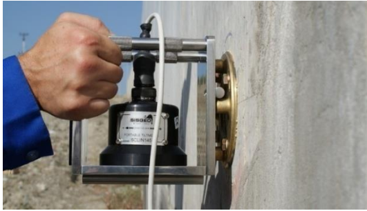
A pochyłomierz przenośny (fot. Sisgeo.com)
