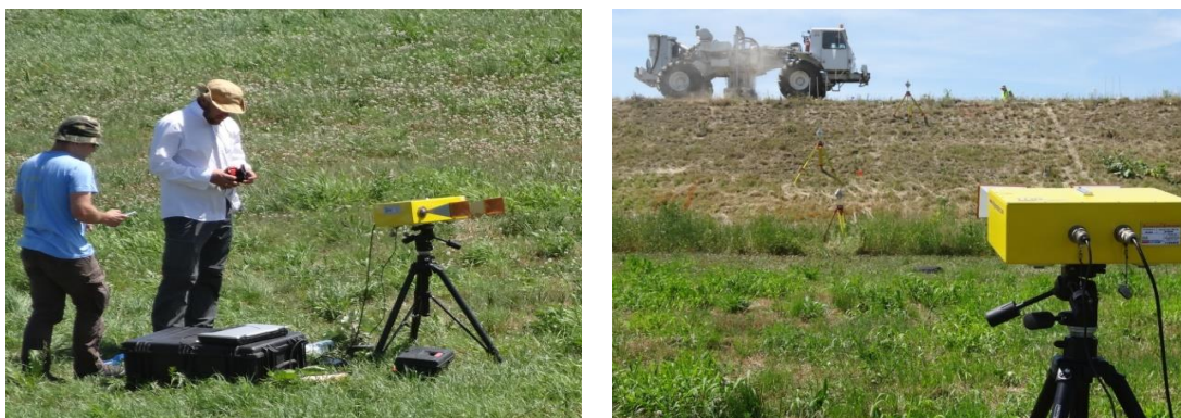
Rysunek 61 Przykład wykorzystania radaru interferometrycznego do pomiaru drgań (fot. A. Borecka)
