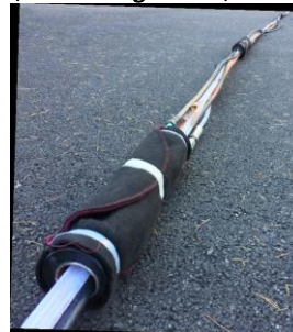
D ekstensometry wieloprętowe (poduszki kotwiące, fot. Sisgeo.com)
