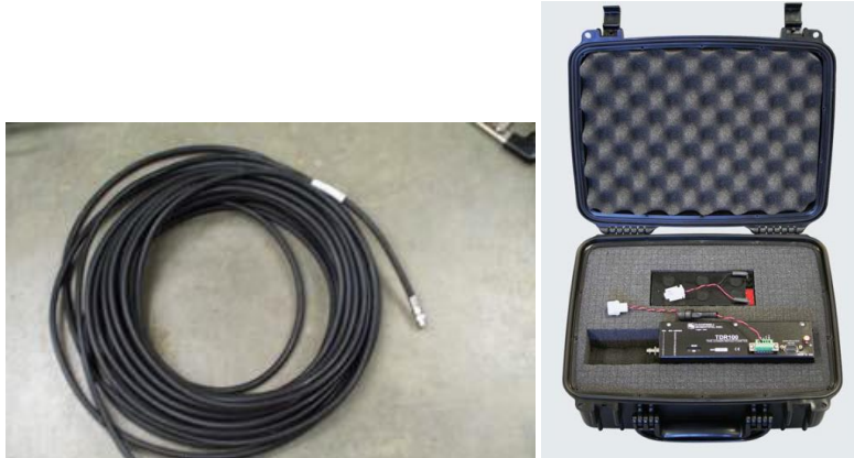
Rysunek 30 Przykład okablowania i przenośnego reflektometru ( www.rstinstruments.com )
