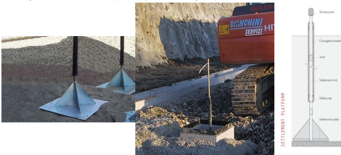
Rysunek 37 Przykład repera wgłębego i jego zabudowy (sisgeo.com)
