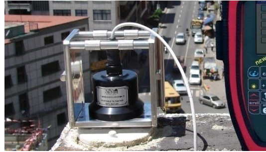
B pochyłomierz przenośny (fot.Sisgeo.com)
