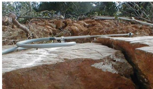
F szczelinomierz precyzyjny (fot. www.spectotechnology.com)
