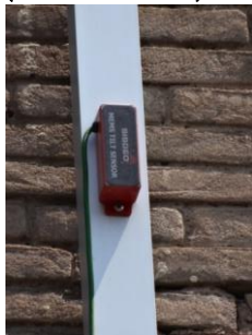
E pochyłomierz precyzyjny zamontowany na belce (fot. A. Borecka)
